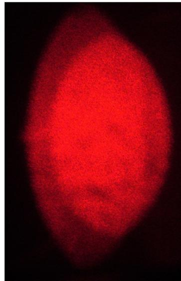
(b) Kein Interferenzmuster erkennbar mit senkrecht zueinander gerichteten Polarisationsfiltern ( $-45^\circ$  und  $45^\circ$ )
