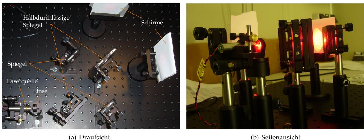
Abbildung 1: Aufbau des Mach-Zehner-Interferometers.
